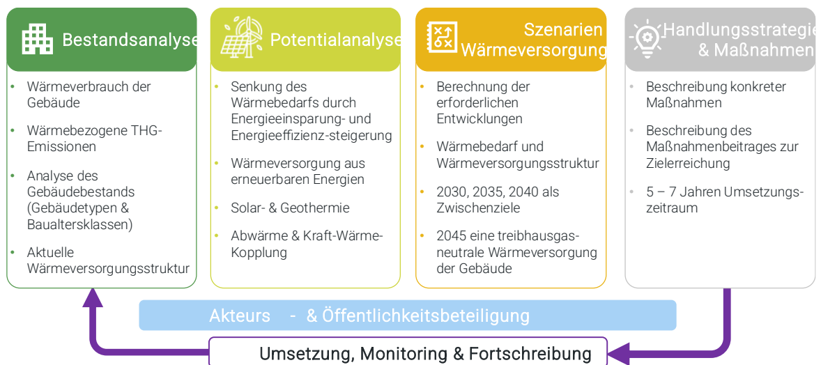
Abbildung 1: Ablaufplan kommunale Wärmeplanung (normales Verfahren)
